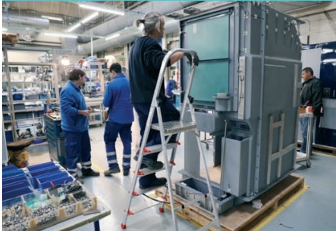
L'empresa Barat Alte fabrica mòduls sanitaris per a vagons de tren a la planta de Lliçà d'Amunt
